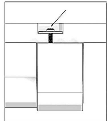
Установите крепежную сборку на декоративную панель дверцы морозильного отделения с помощью винтов. Затем закрепите три металлические скобы винтами (см. Рис). При креплении ручки двери, убедитесь, что части винтов, держащих ручку, не возвышаются над плоскостью декоративной панели.
