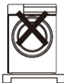
Установка на кронштейн
